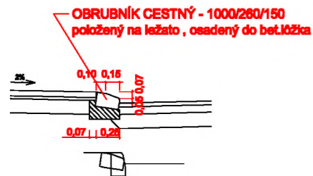
DETAIL OBRUBNÍKA POLOŽENÉHO NA LEŽATO
